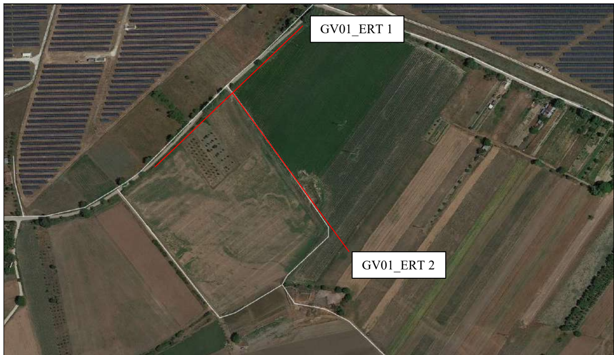
Fig. 1.1 – Immagine aerea con ubicazione degli stendimenti di tomografia elettrica (ERT) all'interno dell'area denominata GV_01
